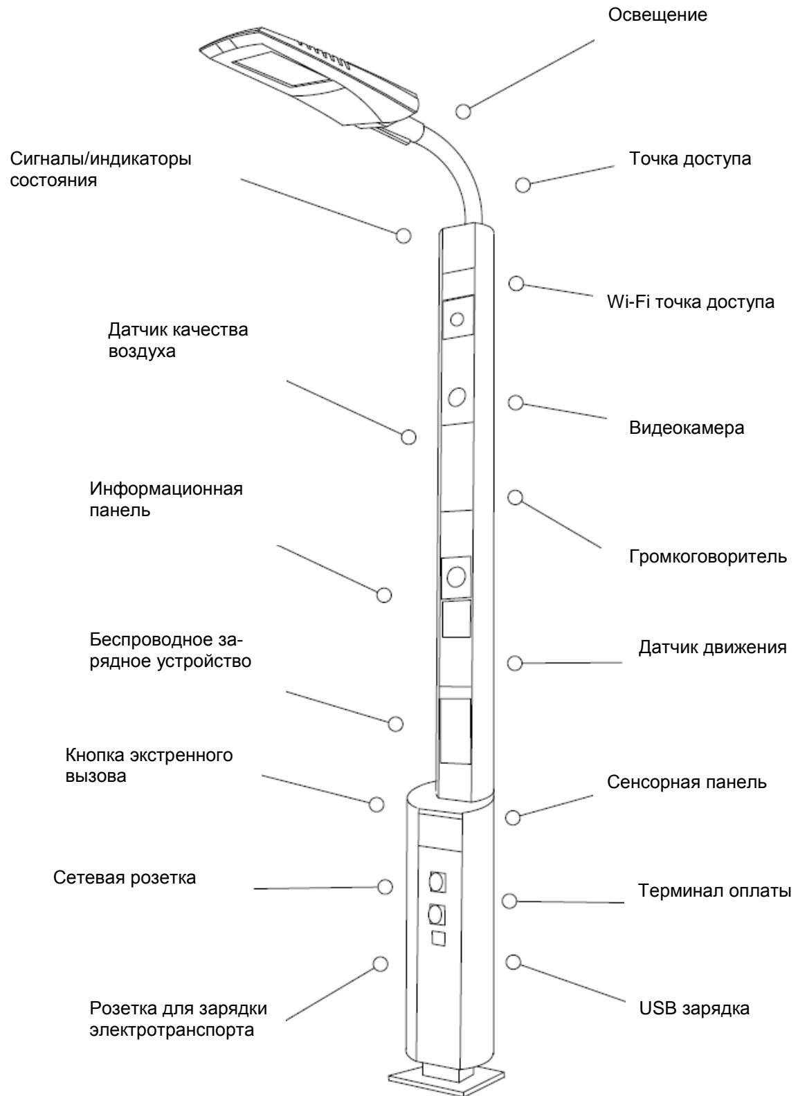
Рисунок Б.2 – Дополнительные элементы осветительной опоры
